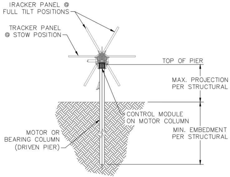
8 EXAMPLE SINGLE-AXIS TRACKER SIDE ELEVATION
